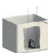
Pompe immergée Version avec moteur étanche pour installation en milieu immergé.
