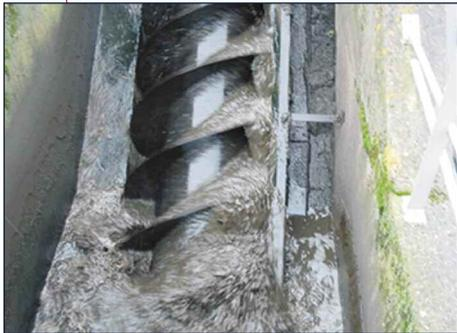
**Bourrage ou blocage d'un convoyeur à vis, le contrôleur de puissance mécanique agit :**
