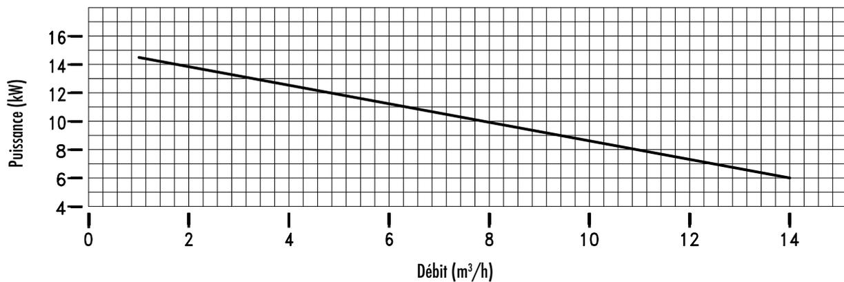
Tolérance de +/- 10% pour la hauteur d'élévation et le débit. Tolérance de +10% pour la puissance.
