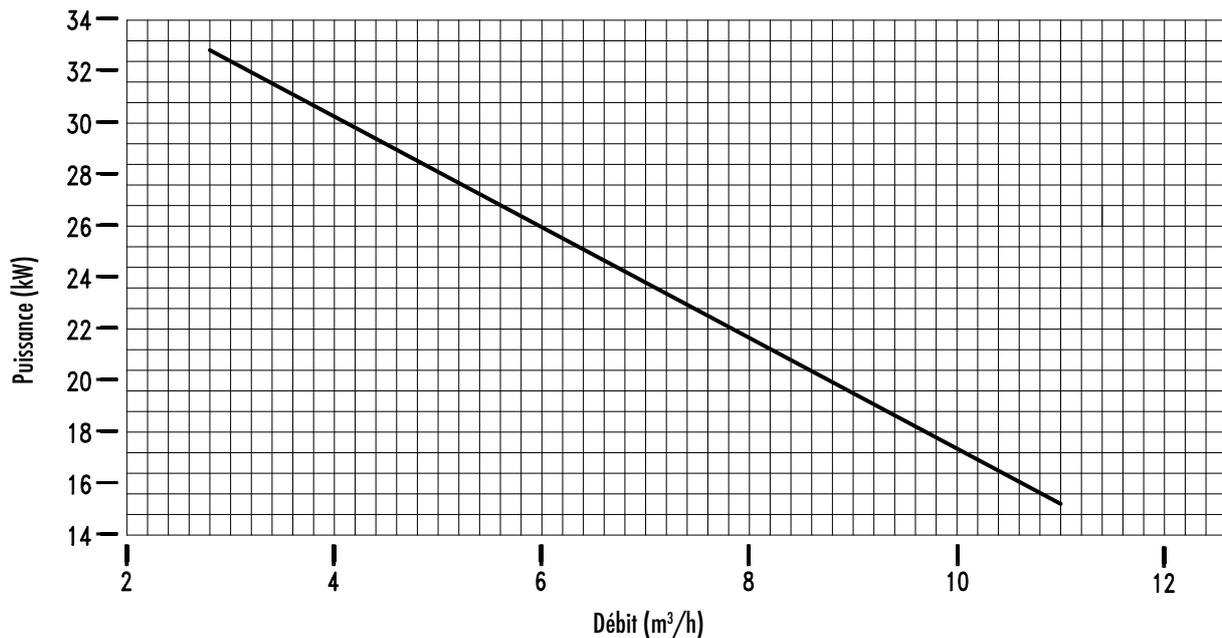
Tolérance de +/- 10% pour la hauteur d'élévation et le débit. Tolérance de +10% pour la puissance.
