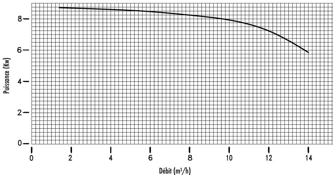
Tolérance +/- 10% pour la hauteur d'élevation et la capacité - Tolérance +10% pour la puissance
