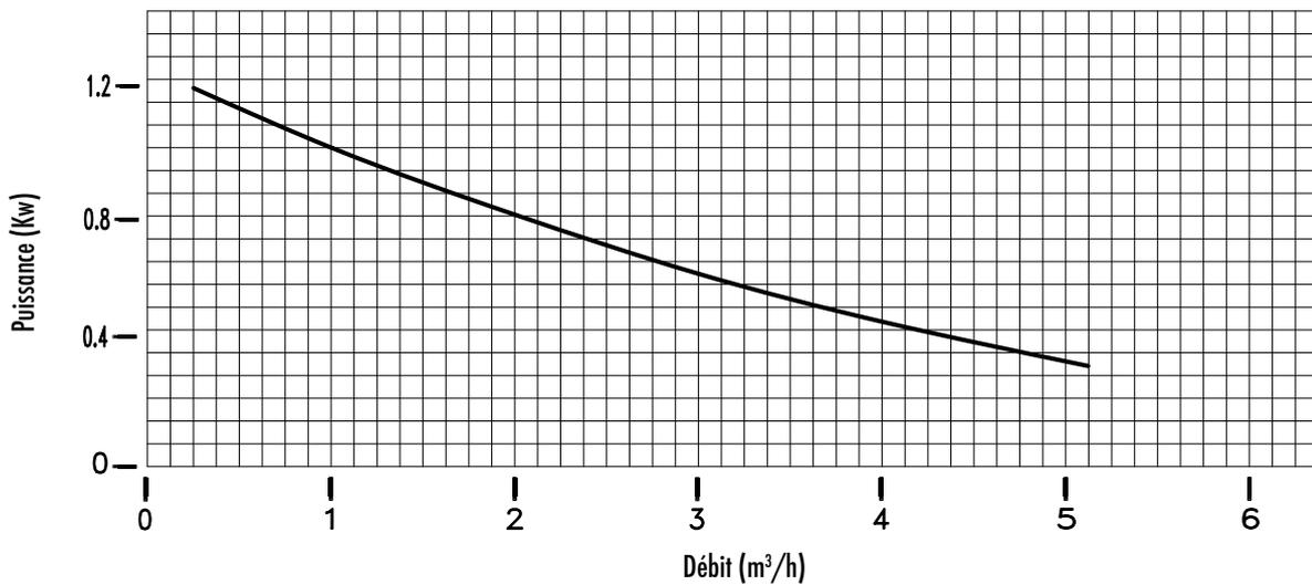
Tolérance +/- 10% pour la hauteur d'élevation et la capacité - Tolérance +10% pour la puissance
