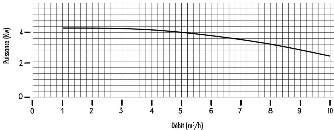
Tolérance +/- 10% pour la hauteur d'élevation et la capacité - Tolérance +10% pour la puissance
