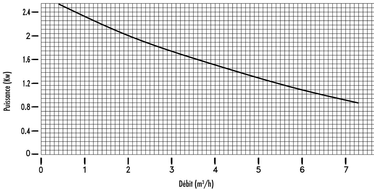
Tolérance +/- 10% pour la hauteur d'élévation et la capacité - Tolérance +10% pour la puissance
