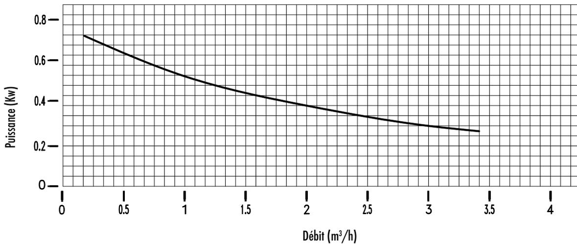
Tolérance +/- 10% pour la hauteur d'élevation et la capacité - Tolérance +10% pour la puissance
