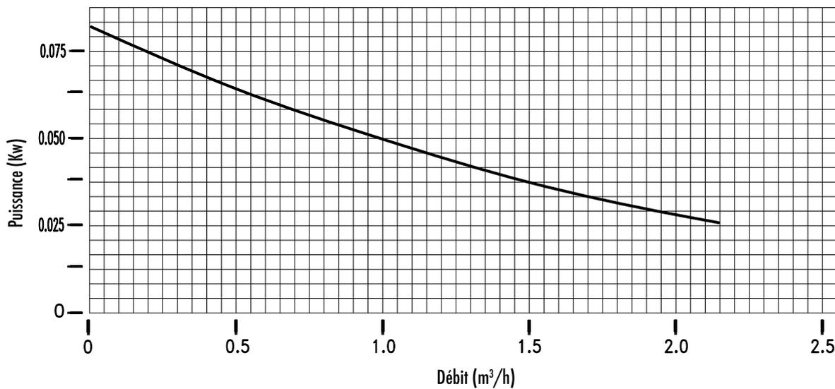
Tolérance +/- 10% pour la hauteur d'élevation et la capacité - Tolérance +10% pour la puissance
