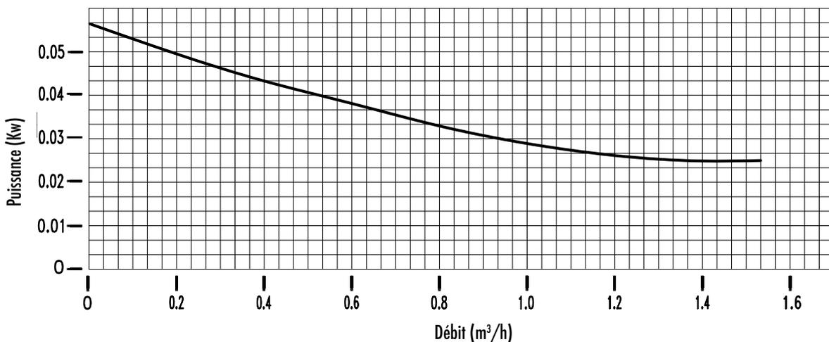
Tolérance +/- 10% pour la hauteur d'élévation et la capacité - Tolérance +10% pour la puissance
