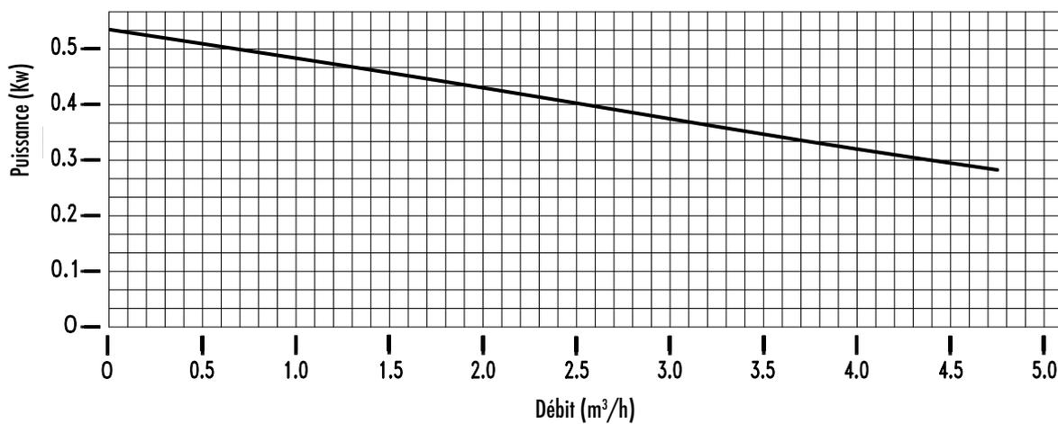
Tolérance +/- 10% pour la hauteur d'élevation et la capacité - Tolérance +10% pour la puissance
