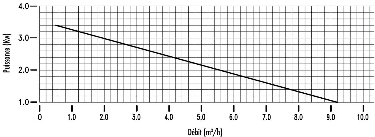
Tolérance +/- 10% pour la hauteur d'élévation et la capacité - Tolérance +10% pour la puissance
