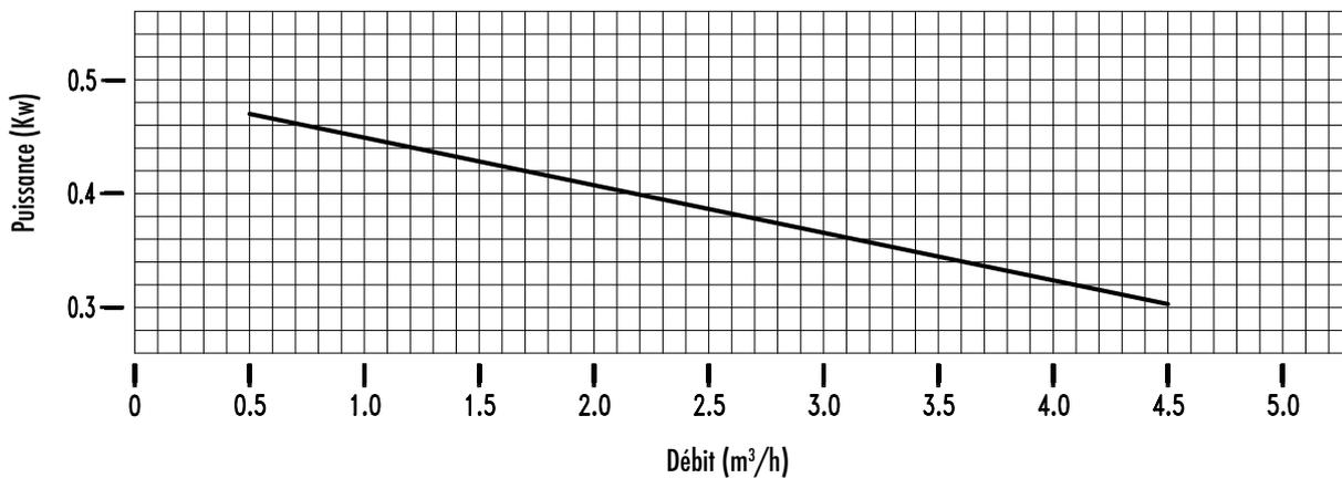
Tolérance +/- 10% pour la hauteur d'élevation et la capacité - Tolérance +10% pour la puissance
