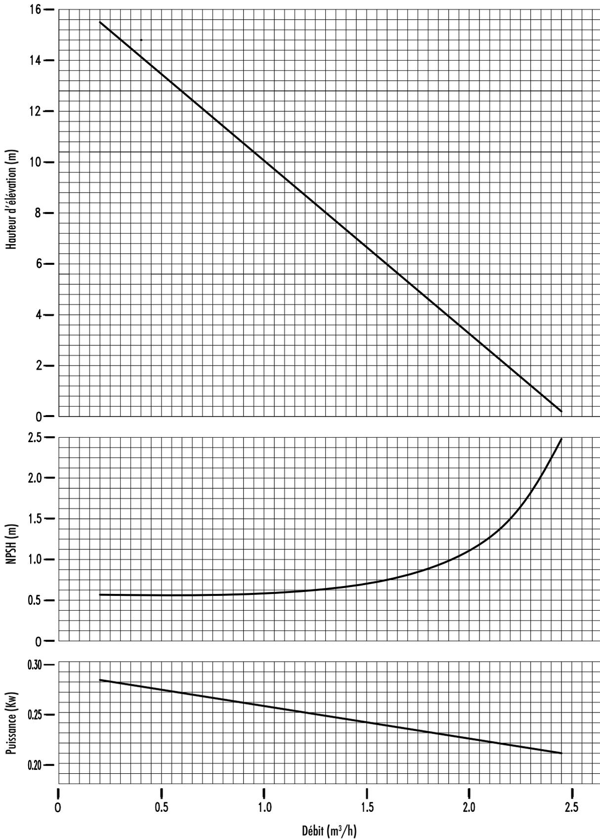
Tolérance +/- 10% pour la hauteur d'élevation et la capacité - Tolérance +10% pour la puissance
