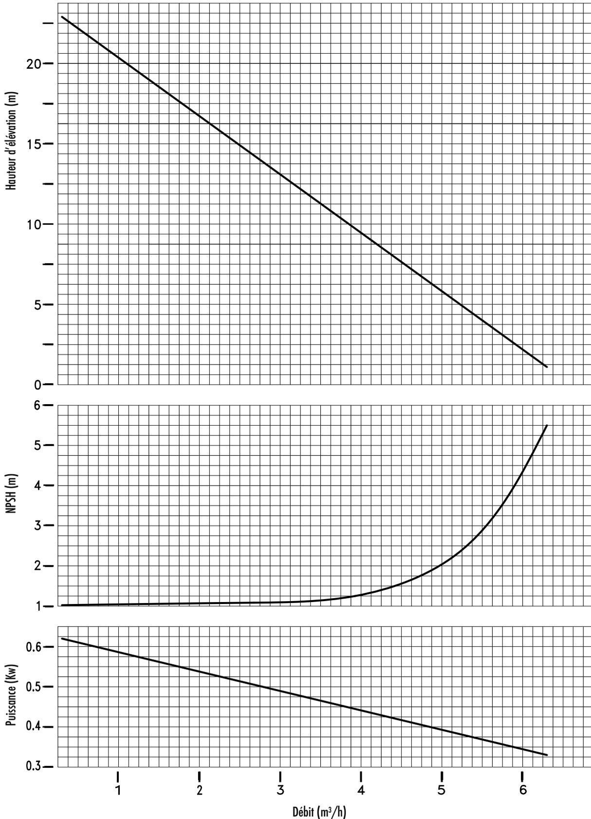
Tolérance +/- 10% pour la hauteur d'élevation et la capacité - Tolérance +10% pour la puissance
