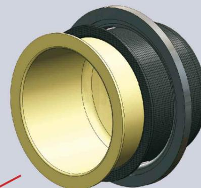
Corps postérieur fabriqué en Polypro, chargé de fibres de verre (PP/GFR) ou en PVDF chargé de fibres de carbone (PVDF/FCR) ou PFA. Un second corps postérieur en composite, de forme ellipsoïdale, renforce la résistance à la pression.
